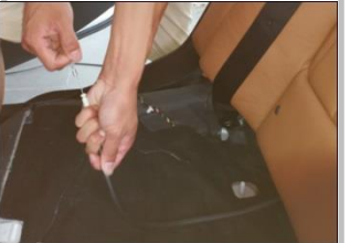
1.15 测试逃生拉线：门锁测试好后，在座位处找到固定点，把逃生拉线固定好防止门锁工作时脱落
