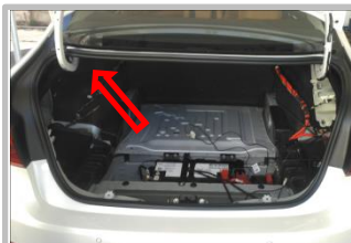
2.1 安装撑杆:拆下原车左测气弹簧撑杆(箭头方向),
