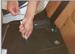
1.14 测试逃生拉线：再用 10 公斤拉力测试已安装在座椅底下逃生拉线能否打开门锁，测试几次确保能打开门
