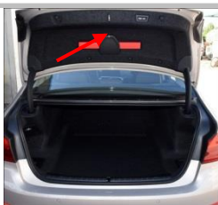
3.17 中控开关输出线接在尾门开关内开关插头
