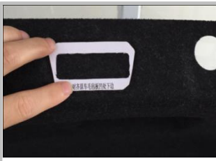
4.2 安装开关按钮：根据定位纸定位在盖板上开孔
