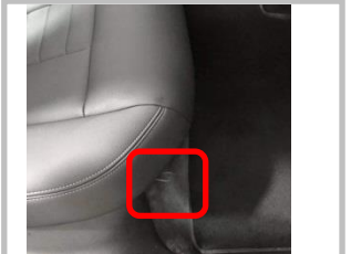
1.12 安装逃生拉线：逃生拉线已穿到座位底下
