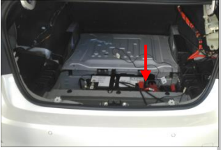
3.9 接正极：看到原车尾箱内部电瓶，我司正极线接原车电瓶正极
