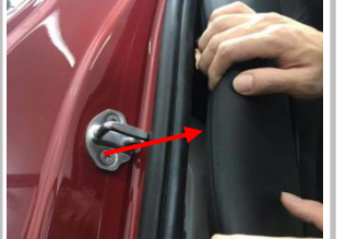
1.9 安装逃生拉线：逃生拉线从此位置穿出(C 柱后排座椅位置)
