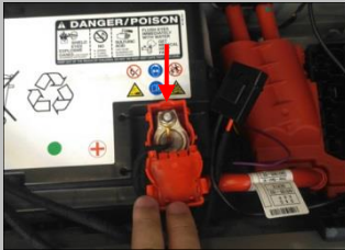
3.10 接正极：揭开电源正极盖用我们的红色线接正极电源，（箭头）
