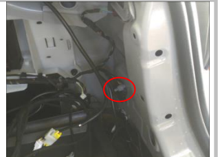
3.12 接负极：松动螺母，卡进负极连接片，卡紧后再还原拧紧螺母
