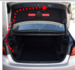
3.3 开关布线:沿着摇臂布线用预留足够线对接后用扎带固定线束
