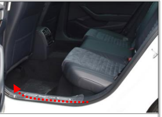
3.15 中控开关线束，在左侧穿线到主驾 A 柱位置
