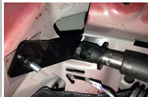
2.6 安装撑杆:将撑杆安装进万向头,注意撑杆方向(电机端朝车头方向),
