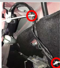
2.7 固定撑杆电机线:由于电机线会摆动,所以必须把电机线与原车线束利用扎带进行固定(红圈内位置)
