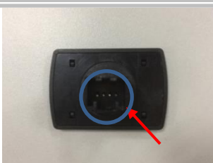
3.23 拆下内饰，根据中控开关，在内饰板上开一个 \varphi 19\text{mm} 的孔
