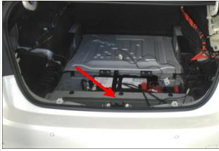
3.7 接信号插头：在尾门门锁位置找到原车信号插头
