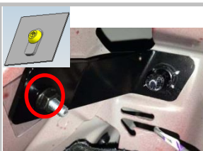
2.3 安装左上支架:T型螺栓与PVC塑料卡块配合,放进原车孔,然后把支架对应空位,用M6螺母稍微紧固
