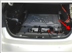
3.11 接负极：尾箱右侧边位置找到原车不带油漆的螺栓柱
