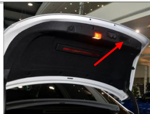
4.1 安装开关按钮：在原车此处装上开关按钮
