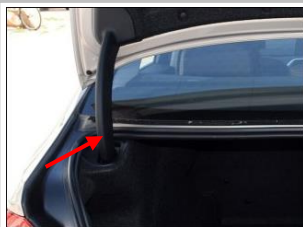
3.2 开关布线:拆卸塑料扣,原车摇臂上的塑料件拆下
