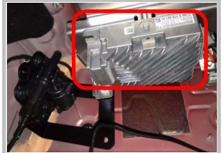
1.6 固定驱动盒：注意配置不同，图示红框部件可能有没有，还原原车物料盒后用原车螺母紧紧固。
