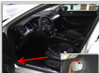
3.16 中控开关线束，中控开关负极接在 A 柱钣金螺栓上
