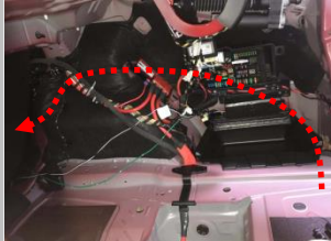
1.8 安装逃生拉线：逃生拉线如图所示穿到右后排座椅底下固定
